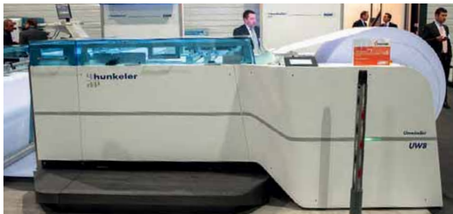
De nieuwe Hunkeler POPPB Unwinder haalt een topsnelheid van 305 meter per minuut.
